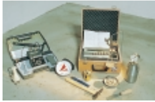
Проверка основания на влажность, а также определение температуры и влажности воздуха в помещении.
